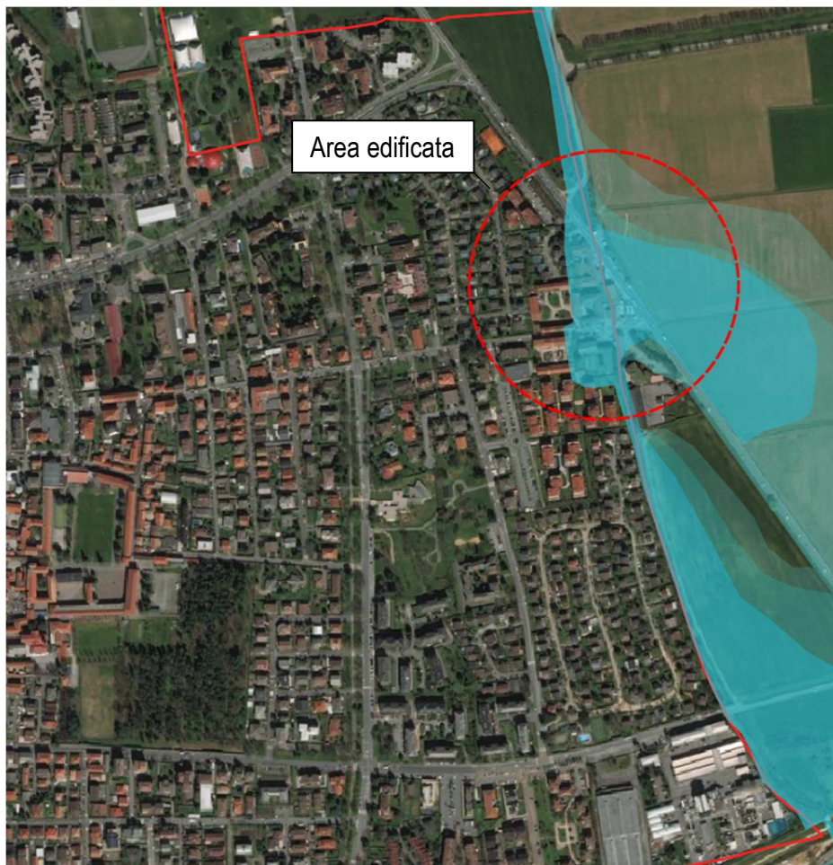
Figura 2 - Area di esondazione del Torrente Guisa da PGRA.
